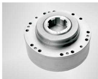
QJM型液压马达与各种油泵、阀及液压件组成液压传动装置，由于它在设计上采取了一定措施，故可适应各种机器工况。该型马达具有重量轻、体积小、调速范围大，可有级变量、工作可靠、寿命长等优点，目前已应用于矿山工程、起重运输，冶金、船舶、机床、塑料加工、地质勘探等领域。主要用在履带行走、轨道轮子驱动、各种回转机构、勘探钻孔、绞车提升、皮带运输传动、物料搅拌、路面切割、船舶推进、塑料注射等部位。
