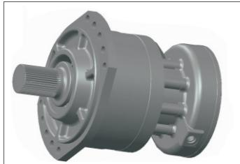
TMS 系列液压马达是一种低速大扭矩的内曲线式径向柱塞马达，采用端面配油方式，滚柱式结构，使用压力高，低速稳定性好，同时可集成各类阀组，制动器，特别适用于车轮式行走驱动工况，此马达广泛应用于矿山机械，起重机械，地质钻探，工程建筑等领域。
