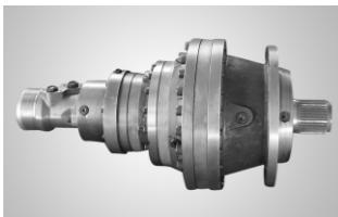
ZCM 液压传动装置由液压马达，多片式摩擦制动器和行星齿轮减速器等组成，具有尺寸小、重量轻、扭矩大、启动效率和传动效率高、噪音低等特点。输出轴可承受较大径向力。液压传动装置适用于各种机械的液压传动机构，回转机构等设备中。
