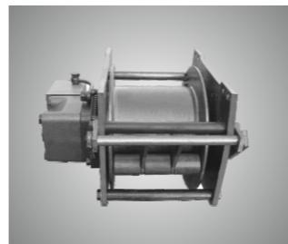
YJ08X/G 系列液压绞车由内置摆线液压马达，行星齿轮减速器，机械制动器等组成。采用螺纹连接钢结构机架，配置梭阀，平衡阀等控制系统，其结构紧凑、占用空间小，安装采用悬挂式，它适用于船舶、码头和汽车等各种起重和牵引的设备中，更适合车载使用。
