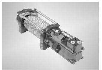
AHW 液压绞盘由液压马达、制动器、卷筒和行星齿轮减速器组成，装于车辆上，由车辆内转向机构的液压系统( 或其它液压源 ) 供油，作为车辆自救、互助等牵拉的工具。绞盘的制动由制动器完成，当换向阀处于中位时，液压系统停止向马达供油，制动器自动制动，绞盘处于制动状态。当卷筒处于自由转动状态时。
