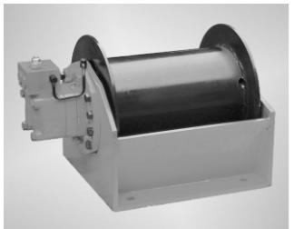
ZYJ 液压绞车是由液压马达,多片式摩擦制动器,行星齿轮减速器,卷筒和支架等部件组成,以整体形式提供。液压绞车自带梭阀和平衡阀,梭阀控制制动器,平衡阀既能防止绞车因工作机构的自重而下落,又能稳定绞车的提升或下降。因此,本系列液压绞车除具有的可以无级改变提升或下降速度,起动性好的优点外,还具有运转平稳,工作可靠,安装使用方便等特点。广泛用于各种车载起重机,铁路、采矿、船舶、港口等起重设备上。
