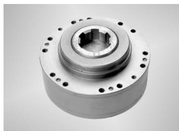
QJM型液压马达与各种油泵、阀及液压件组成液压传动装置，由于它在设计上采取了一定措施，故可适应各种机器工况。该型马达具有重量轻、体积小、调速范围大，可有级变量、工作可靠、寿命长等优点，目前已应用于矿山工程、起重运输，冶金、船舶、机床、塑料加工、地质勘探等领域。主要用在履带行走、轨道轮子驱动、各种回转机构、勘探钻孔、绞车提升、皮带运输传动、物料搅拌、路面切割、船舶推进、塑料注射等部位。
