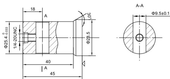
P95:  $\Phi 25.4$ 平键轴, 距轴 $12.7$ 处 $\Phi 6.4$ 通孔,
