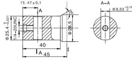
P93:  $\Phi 25.4$ 轴, 距轴18处 $\Phi 9.5$ 通孔
