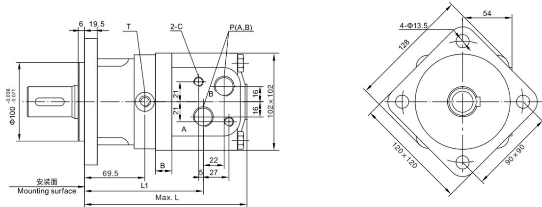
■ BM3Y外形安装图 Installation
