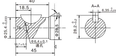
P96:  $\Phi 25.4$ 平键轴, 距轴11.7处 $\Phi 8$ 通孔
