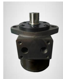
本系列马达是一种轴配流液压马达，该系列马达采用镶柱式转定子副，壳体采用足够强度的球墨铸铁铸造而成，适用于负载较小且间隙工作场合，使用性能好，广泛应用于农业、林业、塑料、机床、矿业机械，如注塑机的调模，清扫机、锯木机、工作平台等。
