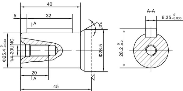
P89:  $\Phi 25.4$ 轴, 距轴 $15.47$ 处 $\Phi 9.53$ 通孔
