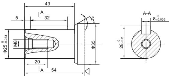
P4:  $\Phi 25$ 平键轴, 平键 $8 \times 7 \times 32$
