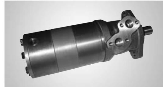
ZBMR 带制动器液压马达是由 BMR 摆线马达和多片式摩擦制动器组合而成，本马达自带梭阀，内置控制油路，结构紧凑，径向尺寸小，具有体积小、重量轻，使用安装方便等特点。适用于建筑、船舶、起重运输、港口、矿山、冶金和其他工程机械行业等设备中。
