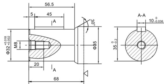
P2:  $\Phi 31.75$ 平键轴, 平键 $7.96 \times 7.96 \times 36$
