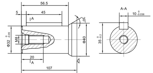
P6: Φ32平键轴, 距轴端30处Φ8.1通孔, 平键10×8×45
