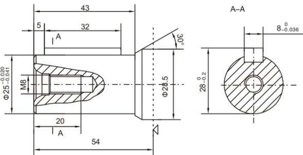
P3:  $\Phi 25.4$ 平键轴, 平键 $6.35 \times 6.35 \times 32$
