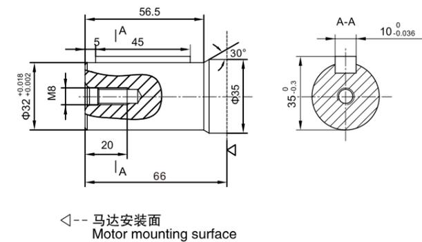
■ BM3Y外形安装尺寸—输出轴 SHAFT VERSION
