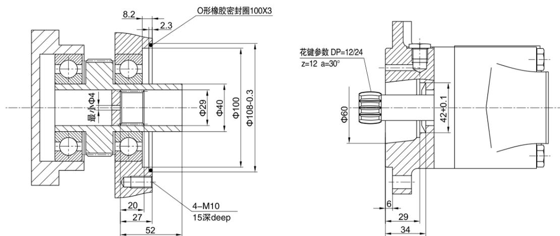
■ BM3S3Y外形安装图 Installation
