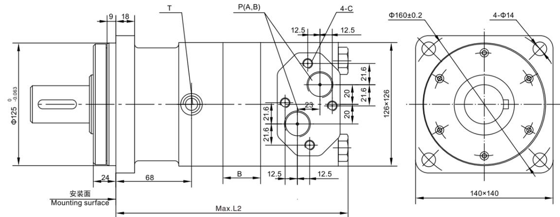
■ BM4 外形安装图 Installation
