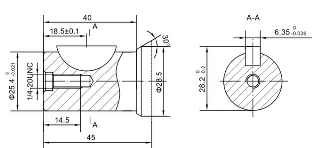
P33:  $\Phi 25.4$ 平键轴, 平键 $6.35 \times 6.35 \times 32$
