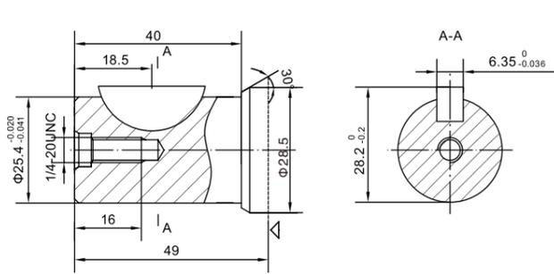
■ BMR, BMRE外形安装图—输出轴 SHAFT VERSION
