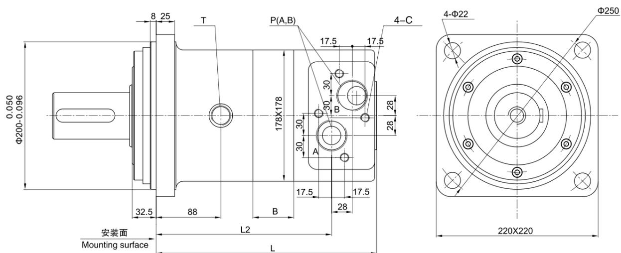
■ BM6 外形安装图 Installation
