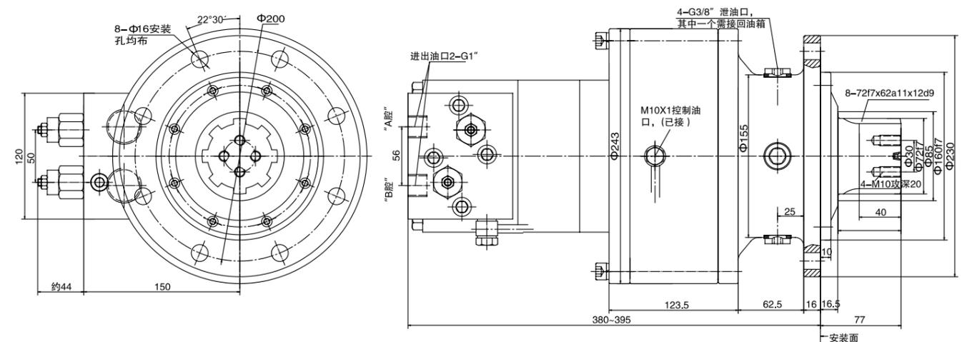
■ ZBM6B/1250-F-H-K3Y2 外形安装图 Installation
