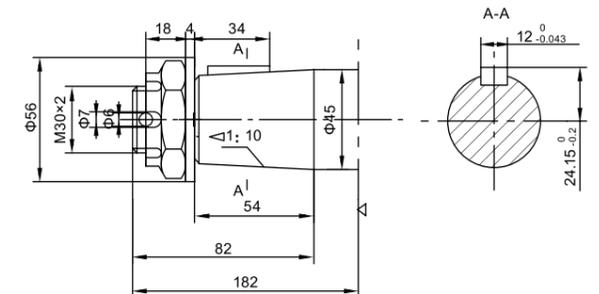
■ BM4S 外形安装图 INSTALLATION
