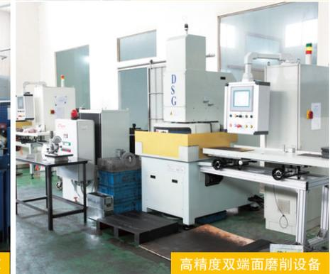
高精度双端面磨削设备
