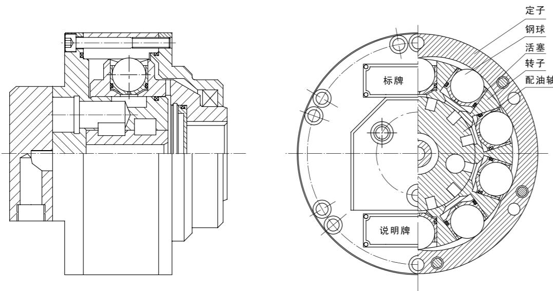
由图可见, QJM型液压马达(标准型)的配油轴是与后盖刚性联结的,而转子体以配油轴作径向支承,以定子滚道和钢球作轴向支承(不另设轴承),它的输出轴是内花键(要求与工作机构输入轴松动配合),所以转子体是浮动的,而配油轴是刚性(它允许用钢管来联结)。压力油经配油轴中通道(或变速阀)分配到通高压腔的配油窗口,进入各活塞缸孔,活塞在压力作用下,通过钢球以N作用到定子上。
