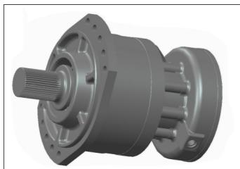
TMS 系列液压马达是一种低速大扭矩的内曲线式径向柱塞马达，采用端面配油方式，滚柱式结构，使用压力高，低速稳定性好，同时可集成各类阀组，制动器，特别适用于车轮式行走驱动工况，此马达广泛应用于矿山机械，起重机械，地质钻探，工程建筑等领域。
