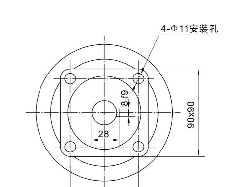
● <sup>1</sup><sub>2</sub>QJM\*\*--\*\*S型自控式带制动器液压马达的技术参数
